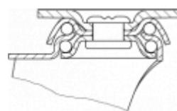
Fabricada con chapa de acero hasta 2 m/m de espesor. Soporte con doble rodamiento a bolas. Acabado cincado. Fabricadas según normas europeas EN 12528.
