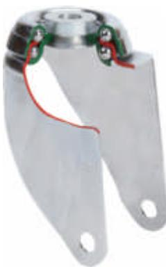
Fabricada con chapa de acero hasta 2 m/m de espesor. Soporte con doble rodamiento a bolas. Acabado cincado. Especialmente diseñada para: Carros de Supermercado. Fabricadas según normas europeas EN 12530.
