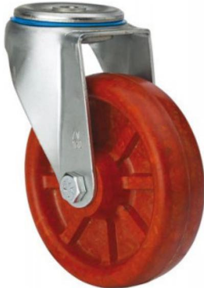
Ruedas de resina extrafuerte, especialmente indicada para soportar altas temperaturas y cargas hasta 600 Kg. Con todos sus componentes de acero inoxidable (AISI 304).
